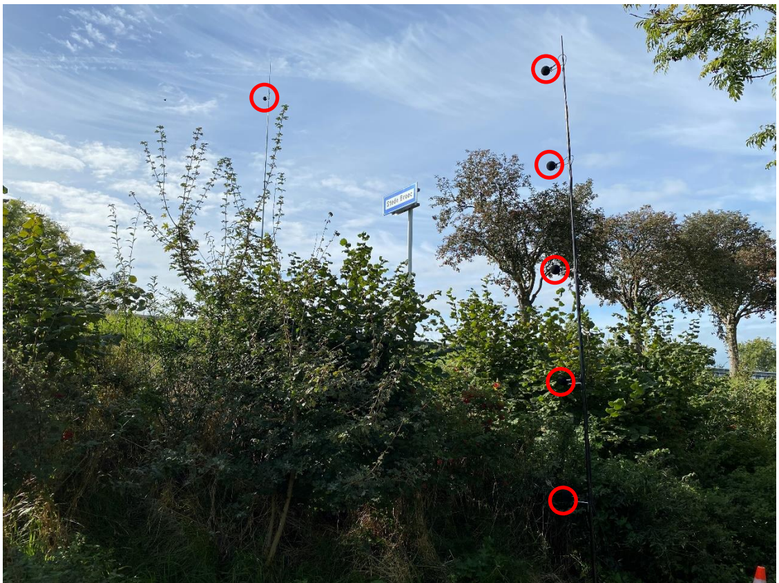
figuur 5 Foto van de meetopstelling met daarin aangegeven de microfoonposities (rode cirkels)
